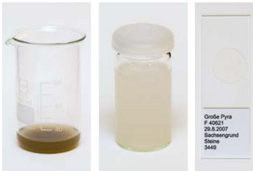
Abbildung 6: Aus dem Gewässer und in ein Becherglas überführte Rohprobe, Suspension nach Säurebehandlung und beschriftetes Dauerpräparat (Fotos: G. Hofmann).
